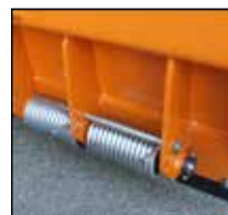
Ribaltamento lame con molle Springs for blade tipping
