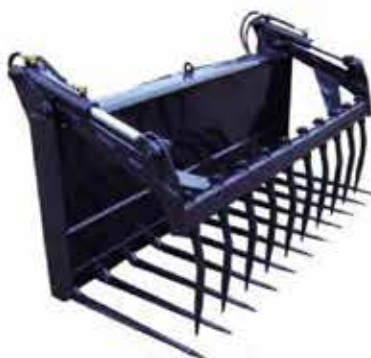
Forcale letame con trattenitore idraulico Manure fork with fastener
