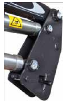
Sgancio rapido senza perni Loader quick release system
