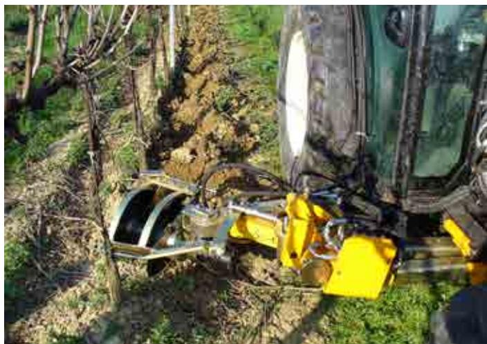
**POLARE con Dischiera scolmatrice - POLARE with motorized disc plough**
