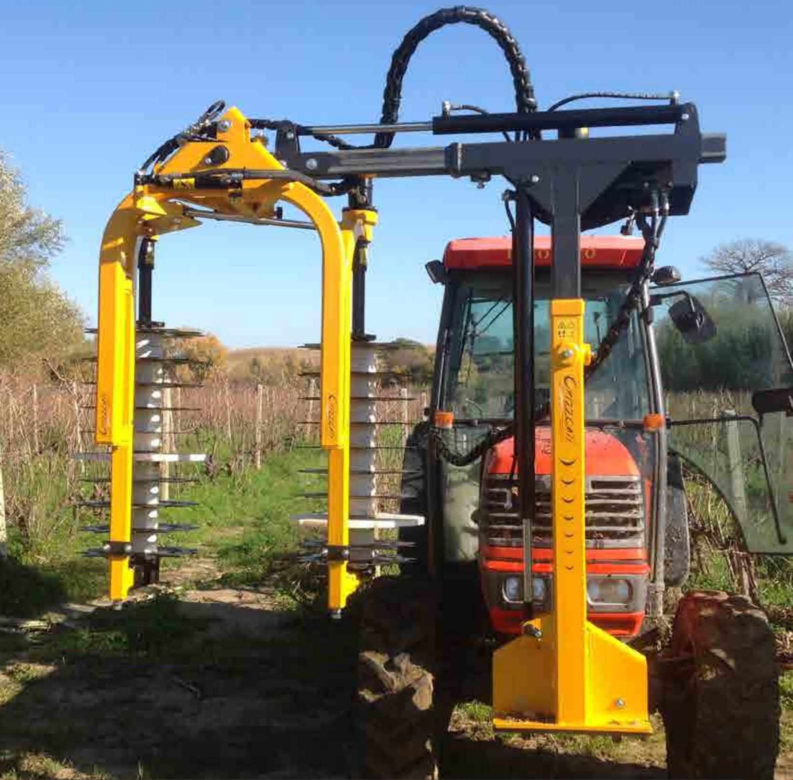
cod. 104501J - versione allestita con distributore elettroidraulico - version equipped with electro-hydraulic distributor
