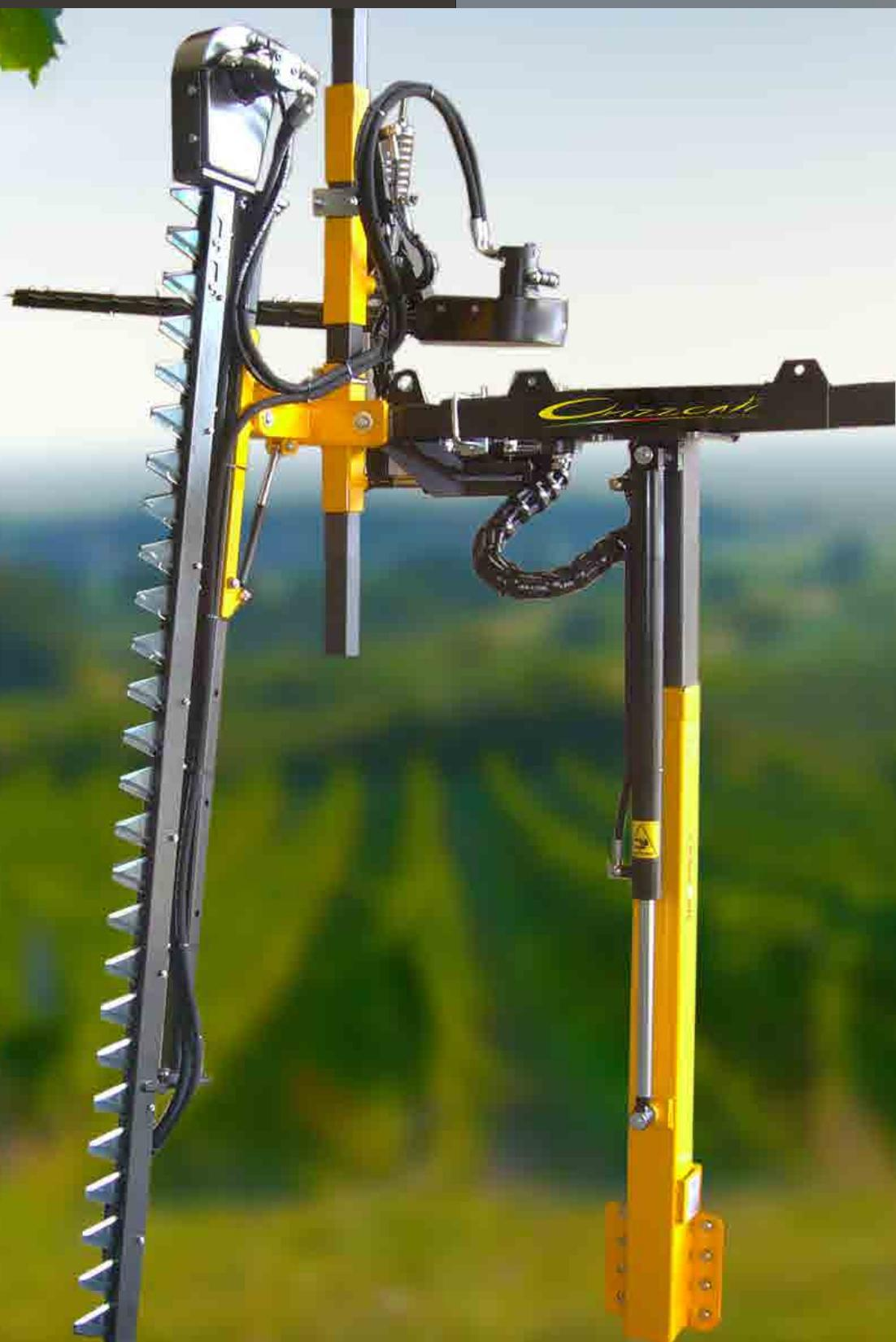
cod. 103211L - versione allestita con distributore idraulico - version equipped with hydraulic distributor
