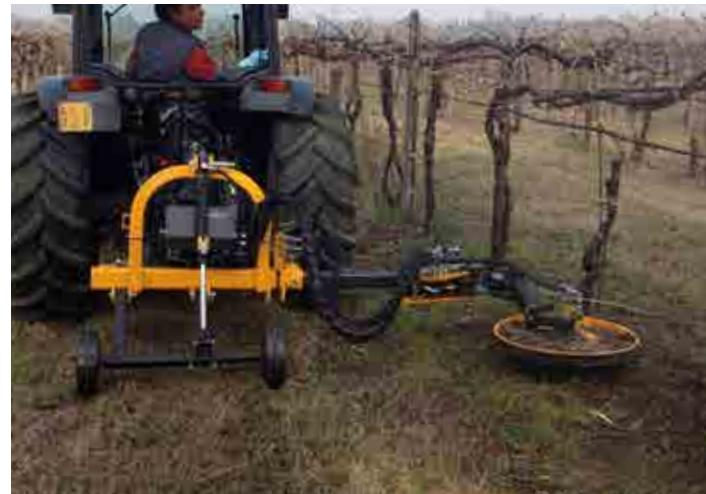
MIRA con Ruota Interfilare - MIRA with Disc mower
