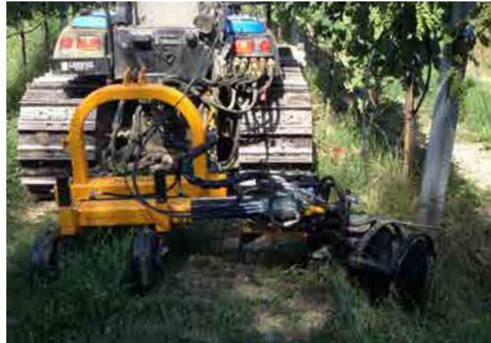
ORION con Dischiera Scolmatrice - ORION with Motorized disc
