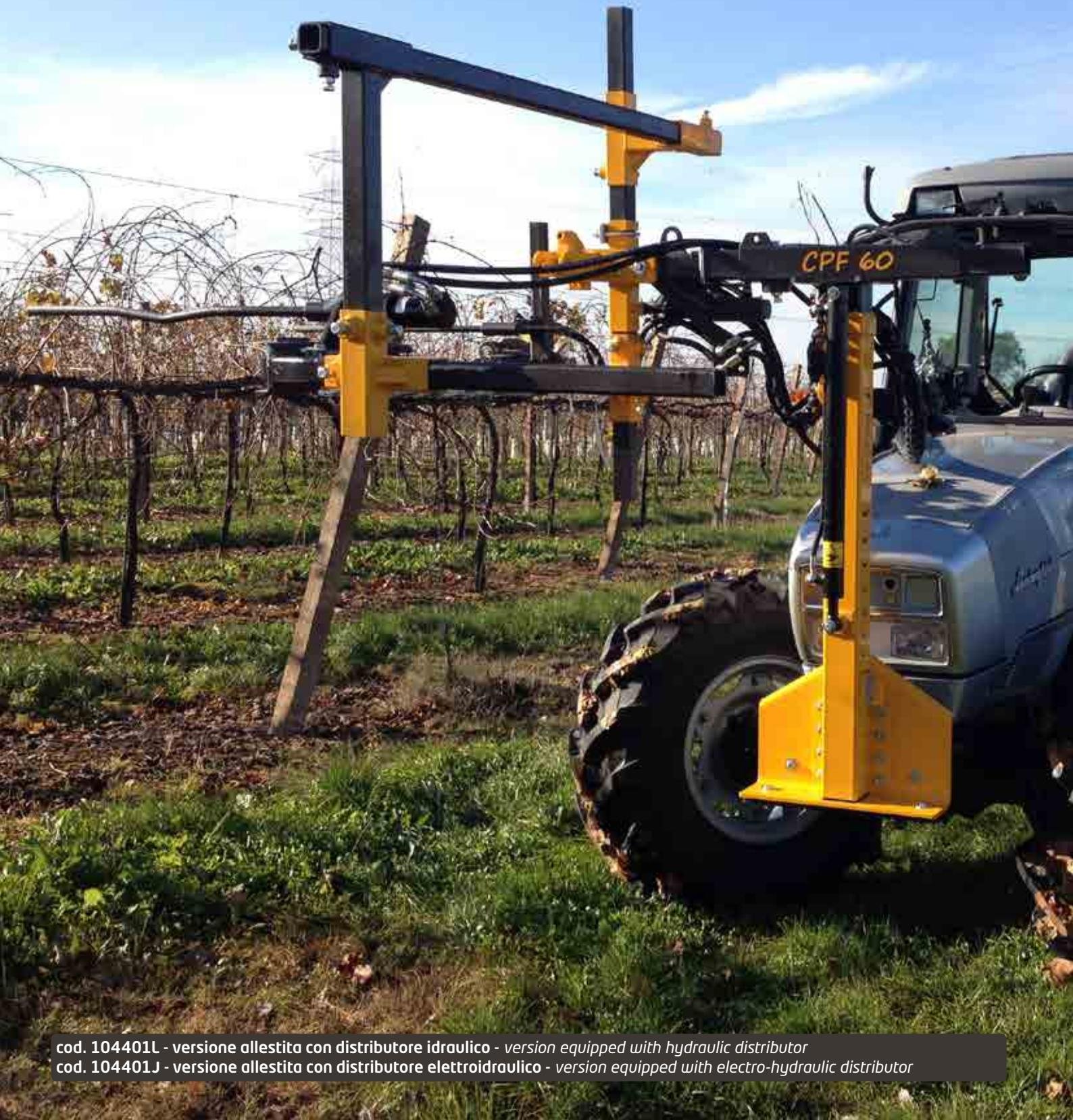
cod. 104401L - versione allestita con distributore idraulico - version equipped with hydraulic distributor
